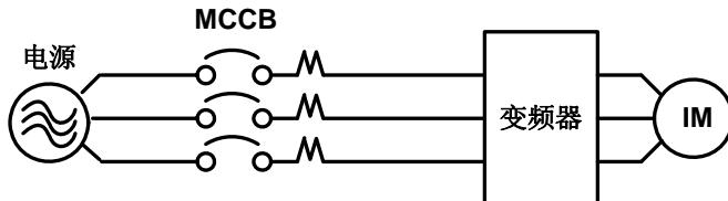
变频器与其它机器共电源回路，请加装变频器用的噪声滤波器或加装隔离变压器
