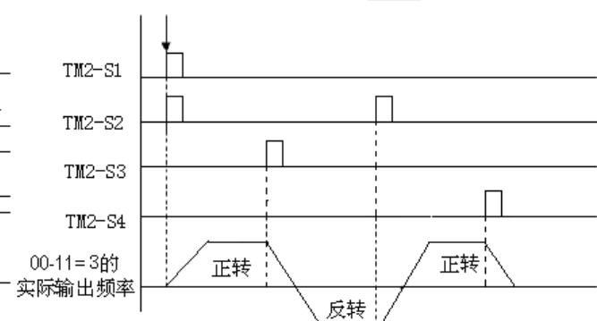
※注：1. 设定 3 线制控制模式后，端子 S1、S2、S3 不受参数 01-00、01-01、01-02 控制
