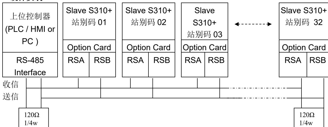
\*\*于通信联机之启始点与最终点请加上 120Ω, 1/4w 之终端阻抗\*\*
