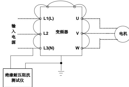
! 决不可对控制电路实施耐压绝缘测试
