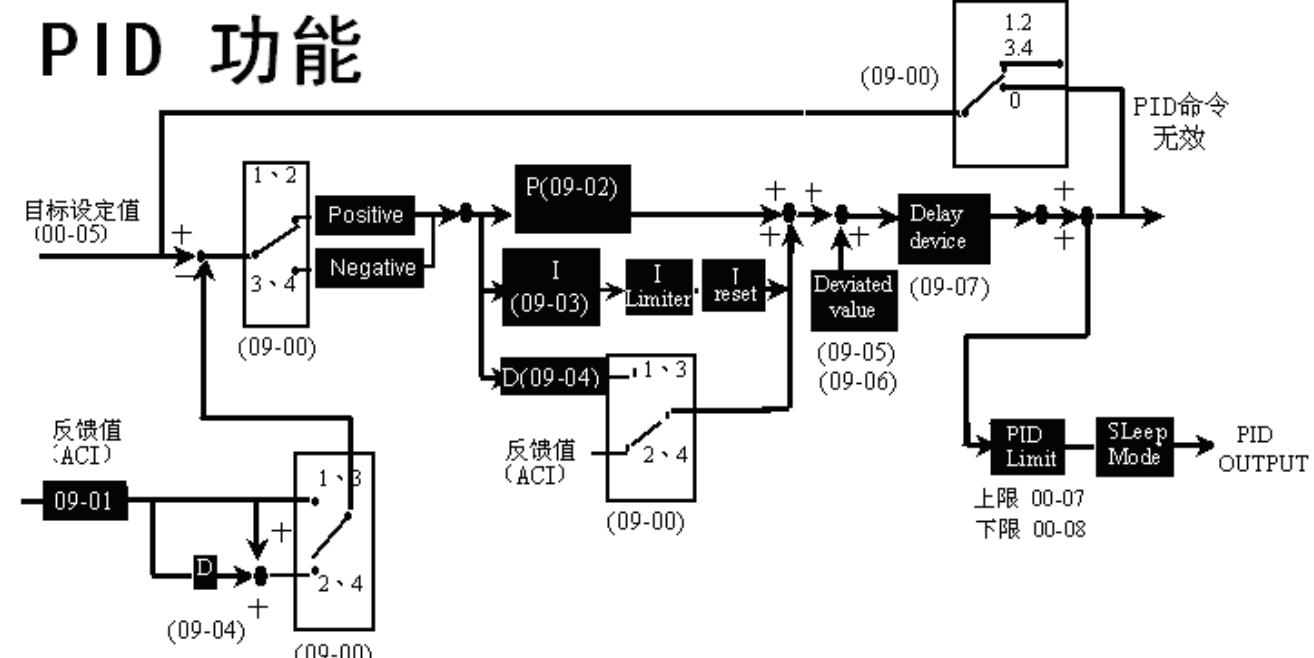
1) 执行 PID 控制时，请将 TM2 上的端子 ACI 设定为 PID 反馈信号，即 02-06=0。
