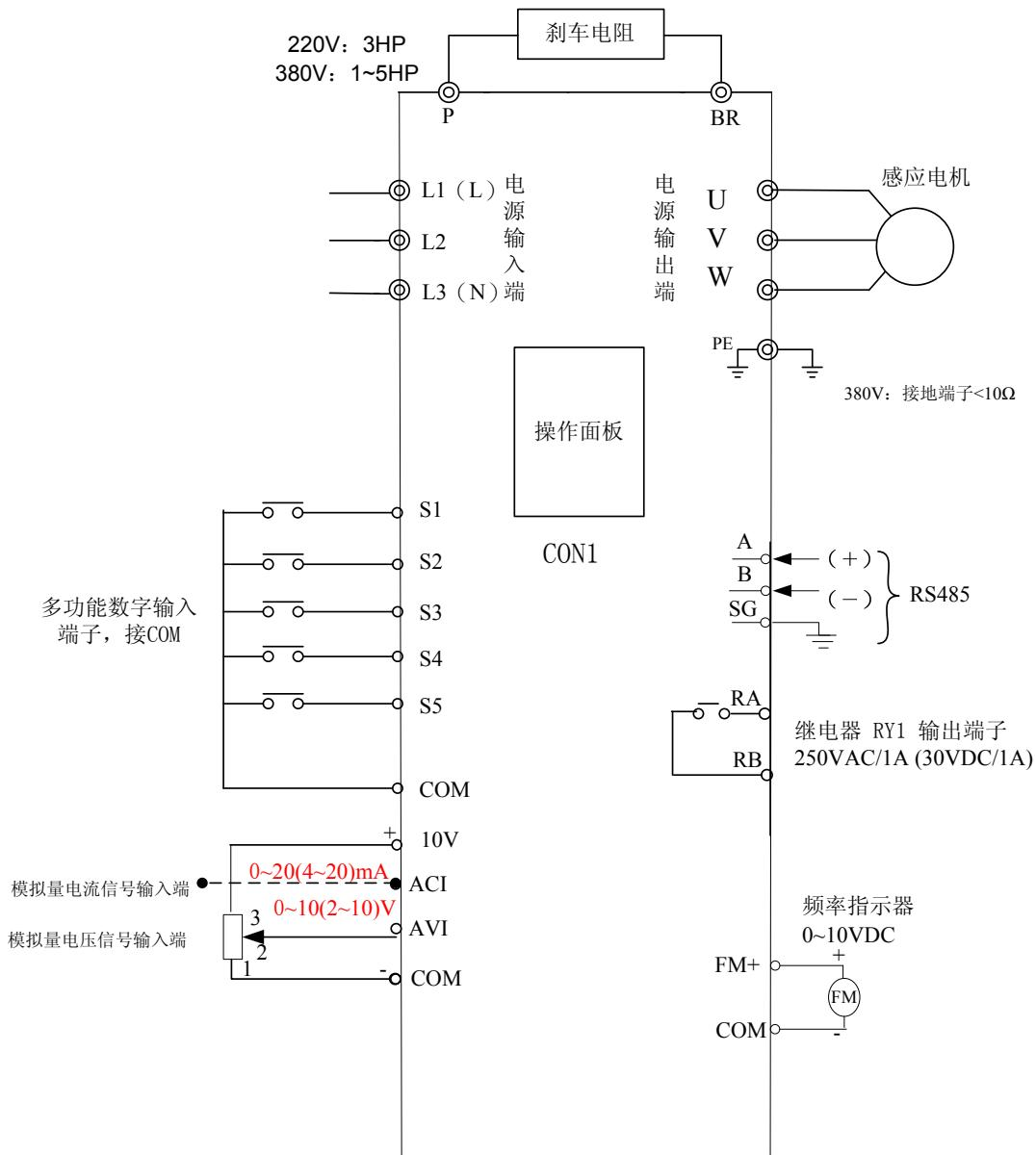
※ 注 1: 使用时请参考主回路端子(P、BR)的说明, 阻值选用参照制动电阻规格。
