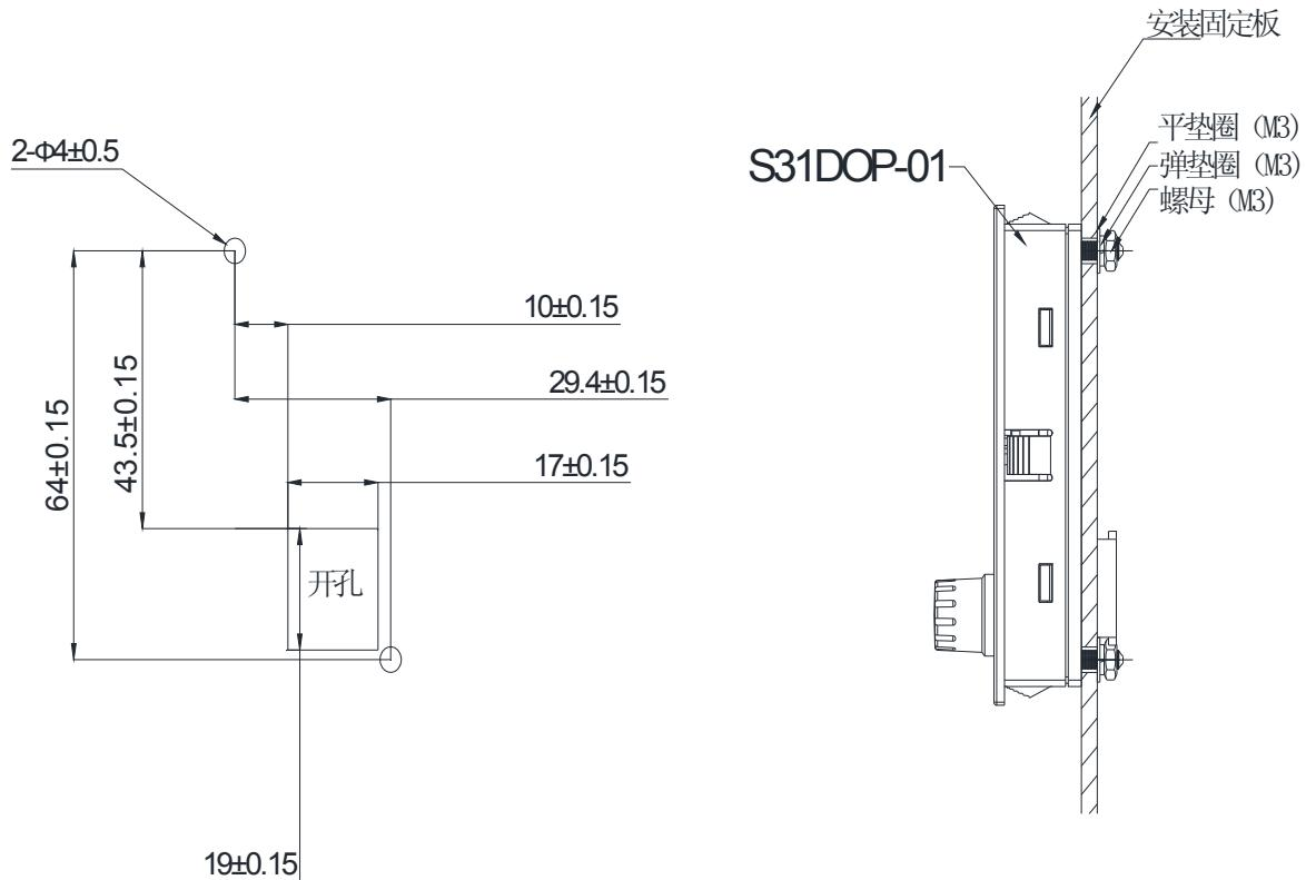
c. 面板无垫圈与螺母安装尺寸图
