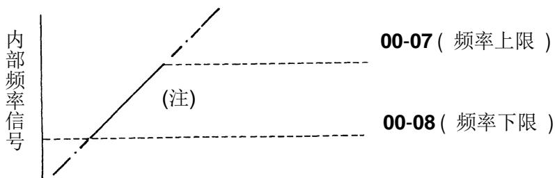
※注：若 **00-08 = 0 Hz**，且频率指令等于 **0 Hz**，则变频器零速停止。
