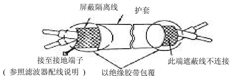
(C) 变频器接地端子请务必正确接地。220V 级：接地阻抗<100Ω，380V 级：接地阻抗<10Ω。
